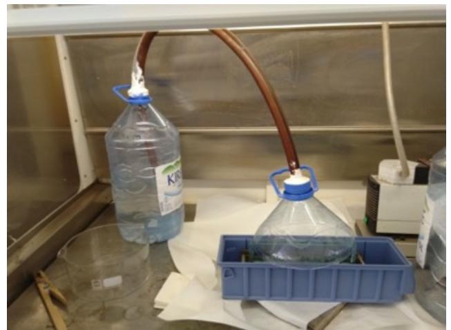
Aspiration avec barboteur pour augmenter la sécurité avec la cuve
